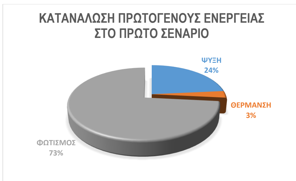
Σχήμα 5.2: Κατανάλωση πρωτογενούς ενέργειας του εξεταζόμενου κτιρίου για το πρώτο σενάριο
